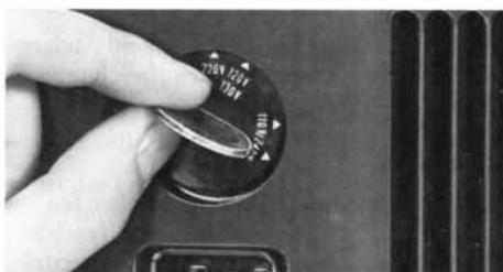
**(Achtung: Der Spannungswähler darf nur umgeschaltet werden, wenn das Netzkabel noch nicht an den Projektor angeschlossen wurde.)**
