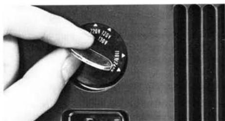
**Attention! le sélecteur de tension ne doit être commuté que si le câble d'alimentation n'est pas encore branché au projecteur.**
