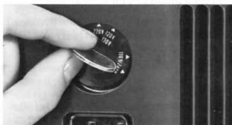
**Attenzione! il cambiatensioni può venir commutato solo quando non sia stato allacciato ancora il cavo di rete.**
