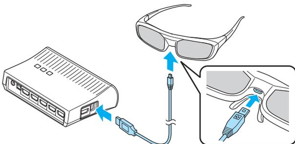
Wenn ein Kabel am HDMI5-Anschluss angeschlossen ist, kann der WirelessHD Transmitter nicht die 3D-Brille laden.
