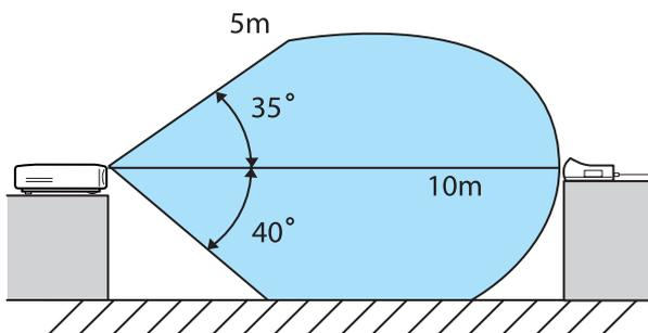
Vertikale Richtung (Deckenaufhängung)
