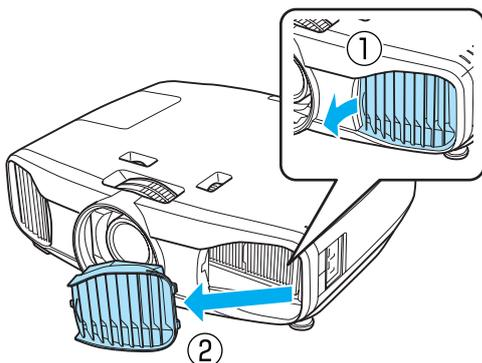
**3** Den Luftfilter entfernen. Halten Sie den Luftfilter am Griff in der Mitte und ziehen Sie ihn schräge heraus.
