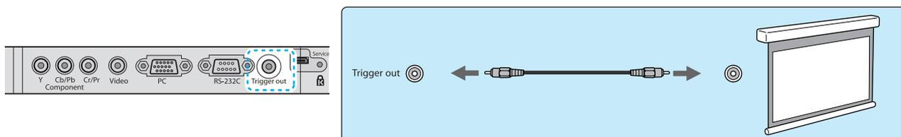
Wenn Sie den Trigger out-Anschluss verwenden möchten, stellen Sie die Funktion Trigger Impuls ein. **Erweitert - Betrieb - Trigger Impuls** [S.77](#)
